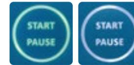
Zum Anhalten/Pausieren die START PAUSE-Taste einmal drücken. Auch das Drücken einer der beiden Programmwahltasten versetzt das Gerät in den Pause-Modus. Der grün leuchtende LED-Ring und die Schrift wechseln auf weiss, und die
