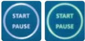
Not-Stopp bei allfälligen Schmerzen). Jetzt kann das Programm durch einmaliges Drücken der START PAUSE- Taste gestartet werden. Der bis jetzt weiße LED-Ring um die Taste sowie die Schrift „START“ und „PAUSE“ leuchten nun grün.
