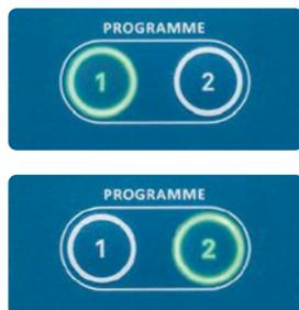
Lors de la mise sous tension de l'attelle de mobilisation Hall-U-Sana®, le programme 1 est présélectionné par défaut. Le chiffre lumineux vert «1» indique que le programme 1 est sélectionné. Appuyez sur la touche «2» pour sélectionner le programme 2. Le chiffre «2» s'allume alors en vert.
